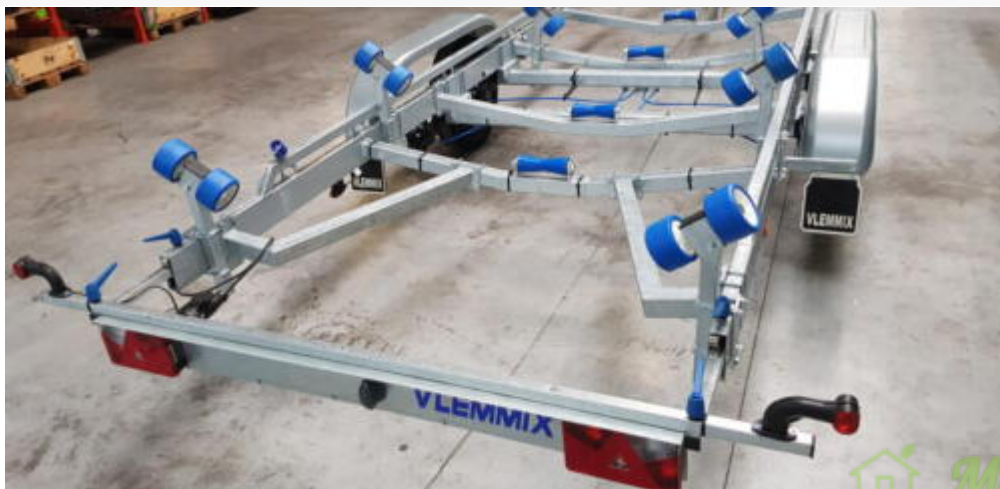
V-konstruktion til bådtrailer
