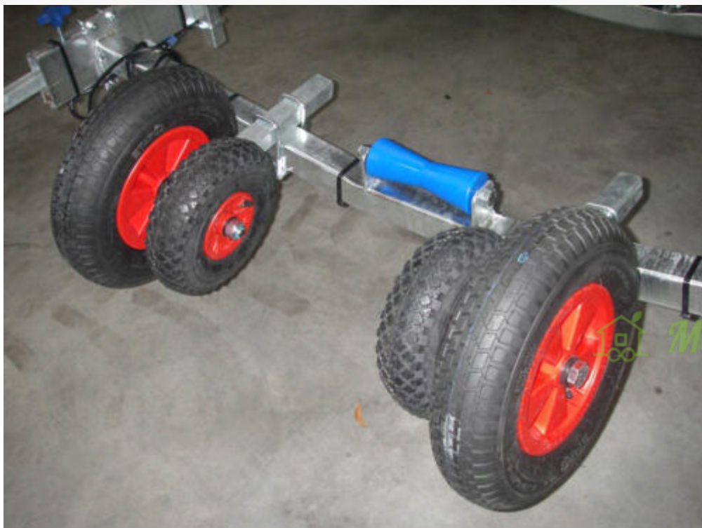
Støtthjul til bådtrailer
