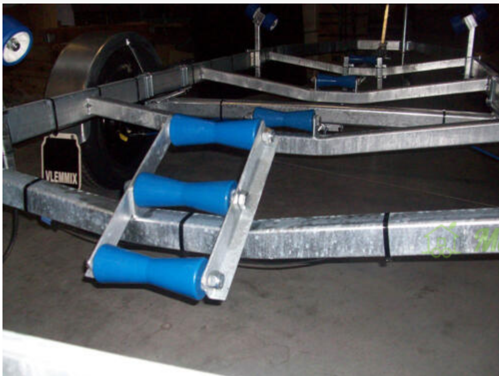
Køl ruller med tiltsystem
